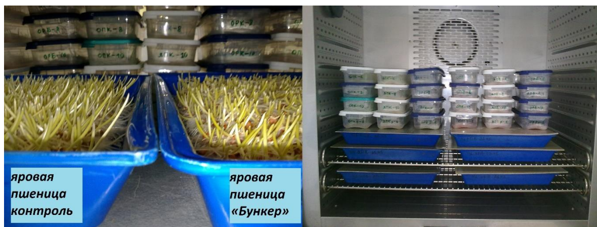
Рис. 6. Кюветы и контейнеры с проростками злаков в камере тепла/холода МКТ-240 (“Binder”, Германия)
