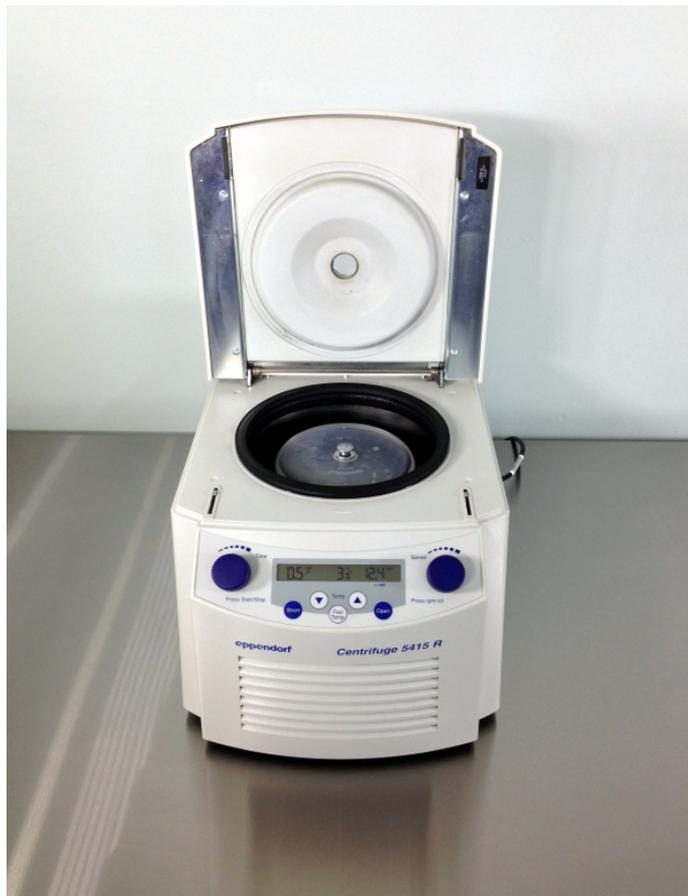
Универсальная центрифуга с охлаждением, предназначена для всех клинических, исследовательских и промышленных лабораторий.
