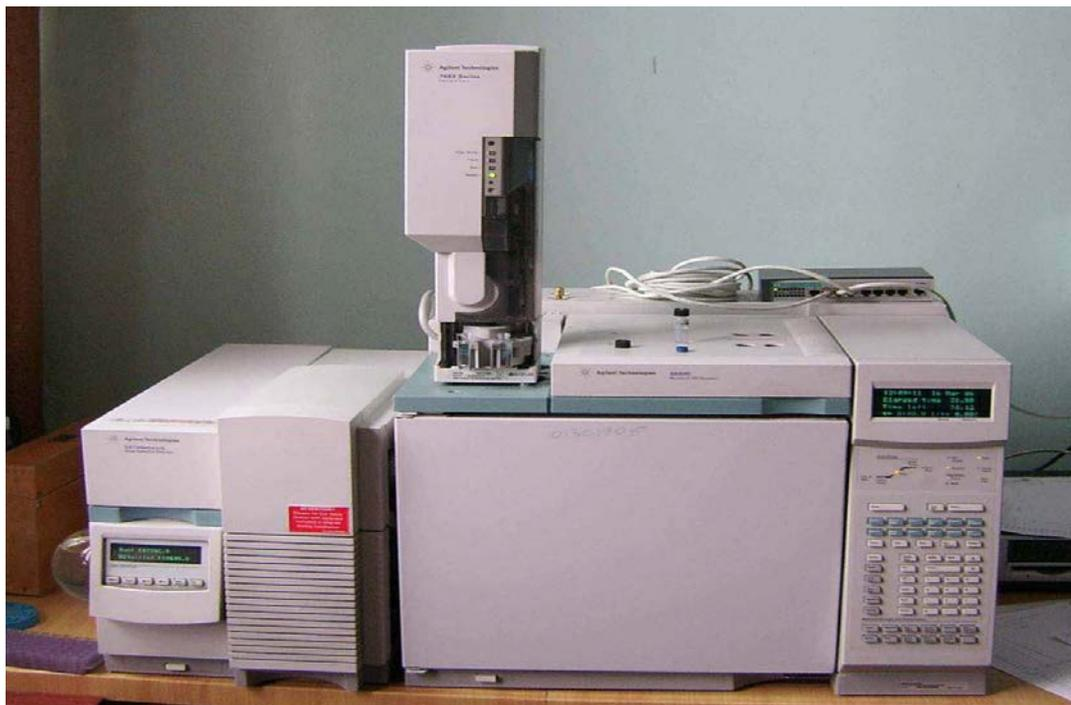
Технические характеристики прибора: детектор – квадруполь, диапазон определяемых масс – 1,6-800 а.е.м., разрешение 0,7-2,5 а.е.м. Тип ионизации – электронный удар, химическая ионизация. Чувствительность в режиме сканирования -1 пг октафторнафталена.  $m/z$  272. Автоматический инжектор, объем вводимой пробы от 0,1 до 5 мкл. Хроматограф – термостат колонки поддерживает температуры в диапазоне от 0 до 450° С.
