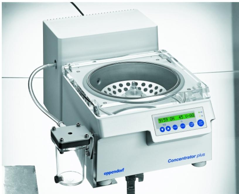
Предназначен для концентрирования (выпаривания) водных образцов (ДНК, РНК, белков и др.) не содержащих агрессивных кислот и щелочей, а также органических растворителей в пробирках объемом от 0,2 до 50 мл (до 144 образцов), а также в 96-луночных планшетах в лабораторных условиях.
