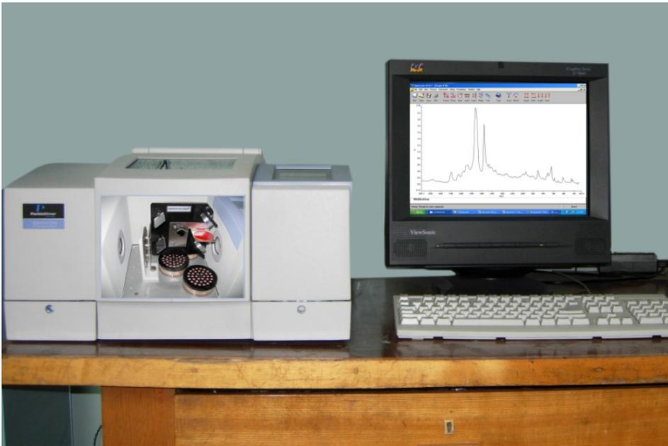
Ближний и средний ИК-диапазон, оптика герметичная осушаемая, защищенная от вибрации. Соотношение сигнал – шум 35000:1, разрешение лучше, чем  $0,5 \text{ см}^{-1}$ .
