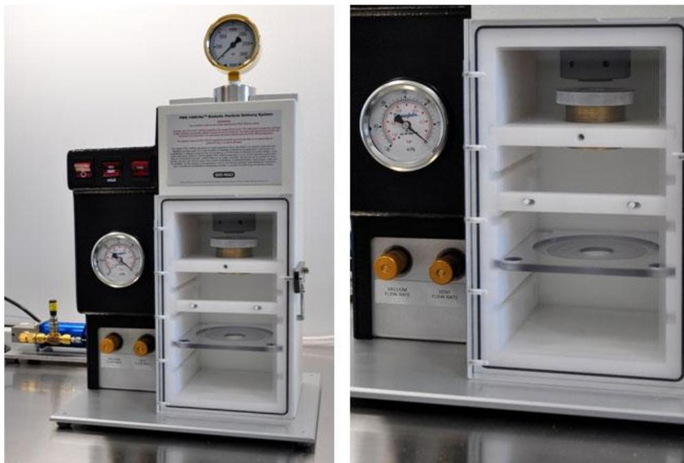
Прибор реализует метод биобаллистической трансформации, заключающийся в том, что ДНК, напыленная на мельчайшие частички вольфрама, платины или золота, диаметром от 0,1 до 3,5 мкм выбрасываются с большой скоростью из пушки и входят в цитоплазму и ядра клеток. Главным преимуществом данного метода является высокая эффективность встройки векторной ДНК, а также то, что можно получить трансгенные клетки в самые кратчайшие сроки.
