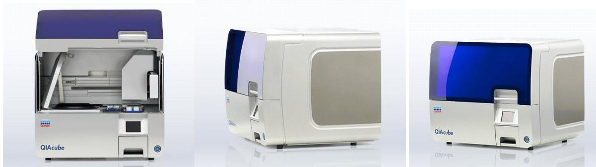
Автоматическая станция для выделения нуклеиновых кислот и белков QIAcube позволяет осуществлять выделение нуклеиновых кислот (ДНК, РНК, миРНК, вирусные нуклеиновые кислоты) и генетически модифицированных белков с использованием колоночного метода выделения.
