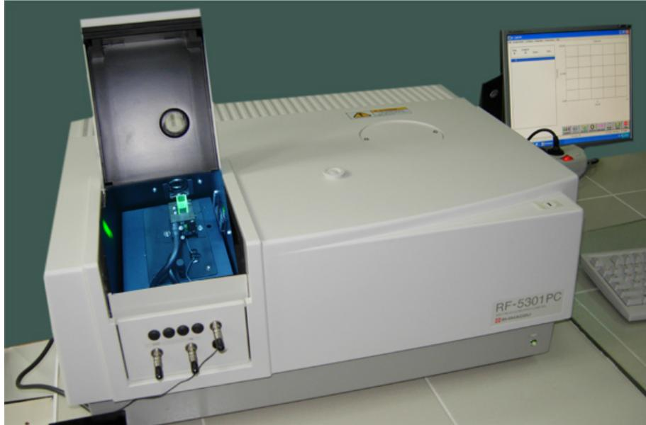
Спектральный диапазон 220-900 нм, изменяемая спектральная щель, соотношение сигнал/шум не менее 150:1, 7 ступеней скорости сканирования, возможность качественного и количественного анализа, автоматическая обработка спектров.
