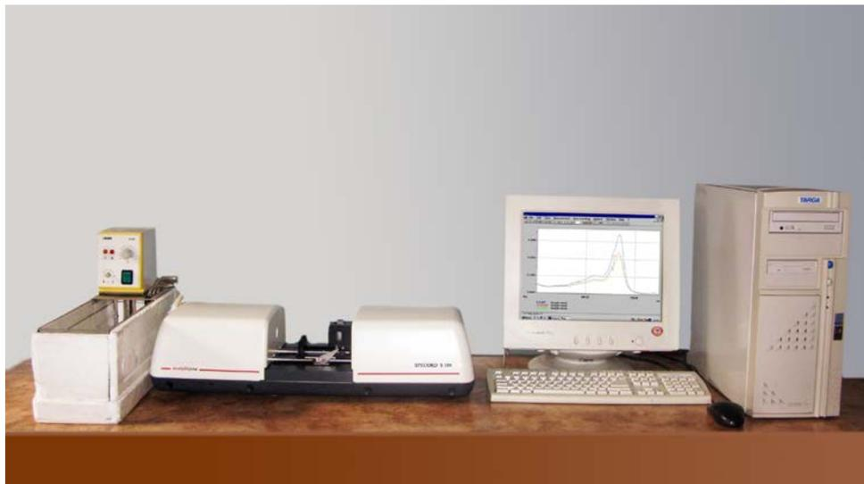
Однолучевой спектрофотометр, полихроматор с голографической вогнутой решеткой и фотодиодной матрицей. Возможна спектрофотометрия окрашенных образцов, спектральный диапазон 190-1100 нм, разрешение лучше, чем 2.0 нм, воспроизводимость длины волны 0,05 нм. Используется для исследования спектров поглощения органических соединений (в том числе пигментов фотосинтетического аппарата), а также, для изучения скорости кинетических реакций в растительных тканях.
